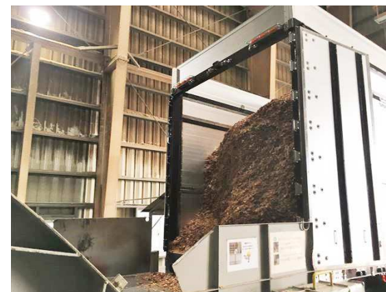
2基のトラックダンパーで投入。4つの燃料バンカーに振り分け。
