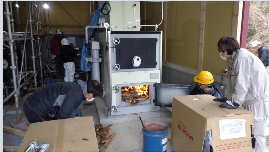
燃焼実験。 人力での薪投入(ローテク)と電子制御(ハイテク)の奇妙な組み合わせ
