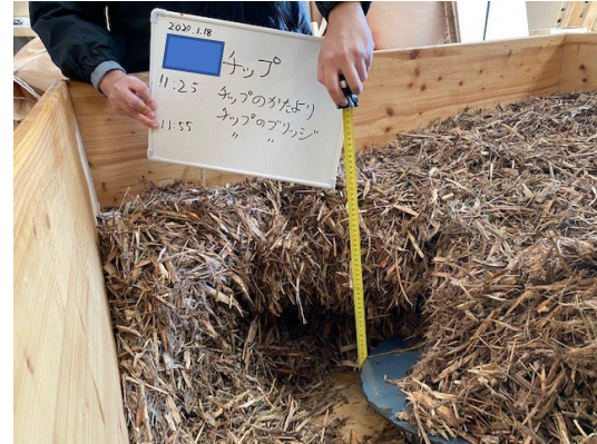
搬送試験 (積み上げ高が低い場合空洞発生)
