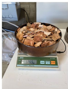
標準的な形状のチップ (切削型)
