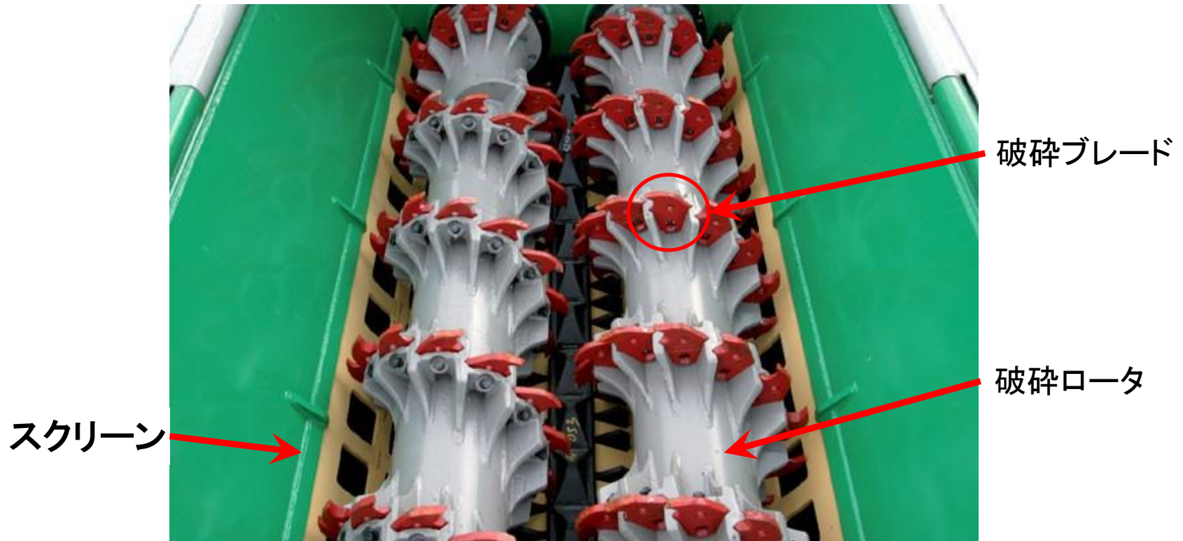
破碎ブレードおよび破碎ロータとスクリーン(下部)
