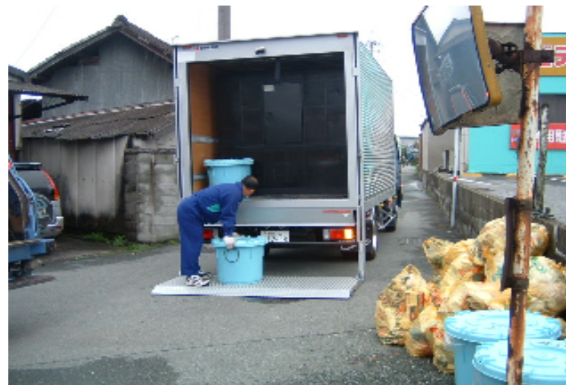
リフト付コンテナ車に よる生ゴミ収集作業
