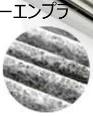
比表面積の大きいナノファイバーで作ったフィルターは小さな塵埃を捕集できます
